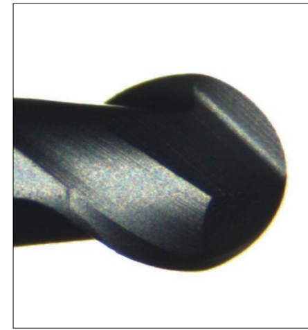
Diamantbeschichteter Fräser Durchmesser 0,10 mm unter einer 750-fachen Vergrößerung.
