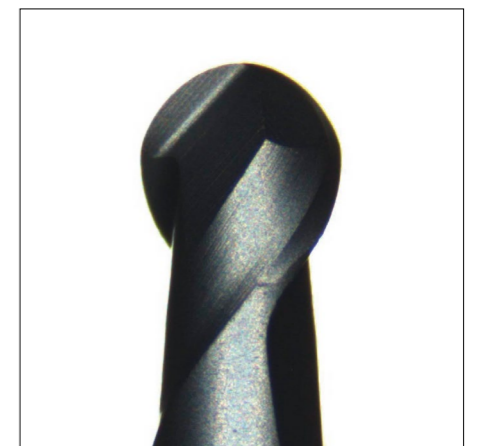
Durchmesser 0,2 mm Kugelfräser unter 450-facher Vergrößerung.
